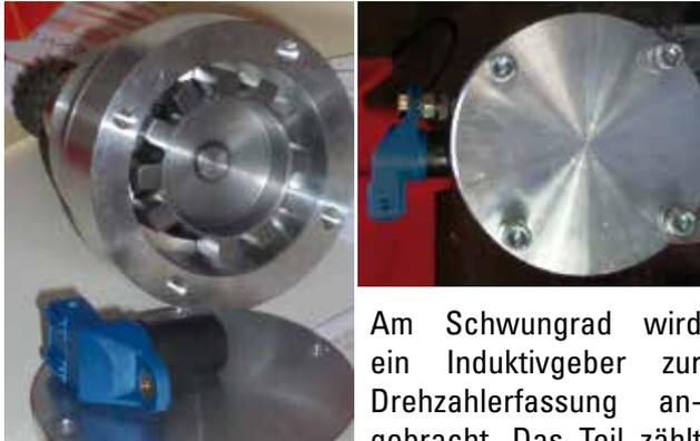
Am Schwungrad wird ein Induktivgeber zur Drehzahlerfassung angebracht. Das Teil zählt
