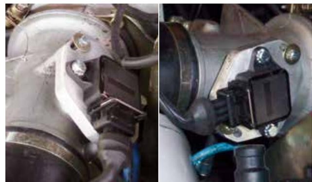
Der Verteiler wird durch ein selbstgedrehtes Teil ersetzt, in dem ein Hallgeber den Offsetwinkel des Zünd-OTs des ersten Zylinders aufnimmt.
